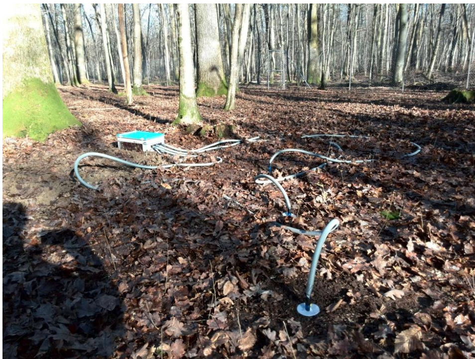
Slika 3.7.2. Set tlačnih lizimetara na plohi 110 Jastrebarski lugovi
