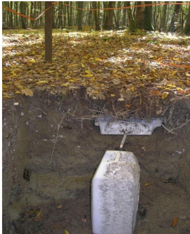
Slika 3.7.1. Gravitacijski lizimetar na plohi 110 Jastrebarski lugovi
