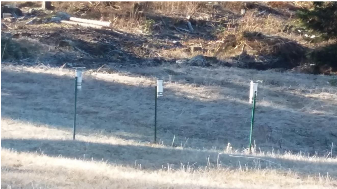
Slika 3.5.1. Kišomjeri na plohi 108 - Poreč (metoda prokaplivanja-THR)
