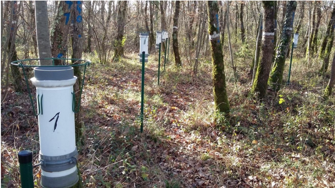
Slika 3.5.1. Kišomjeri na plohi 108 - Poreč (metoda prokaplivanja-THR)
