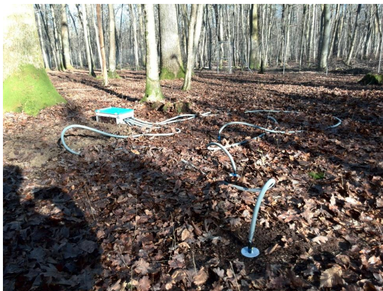
Slika 3.7.2. Set tlačnih lizimetara na plohi 110 Jastrebarski lugovi
