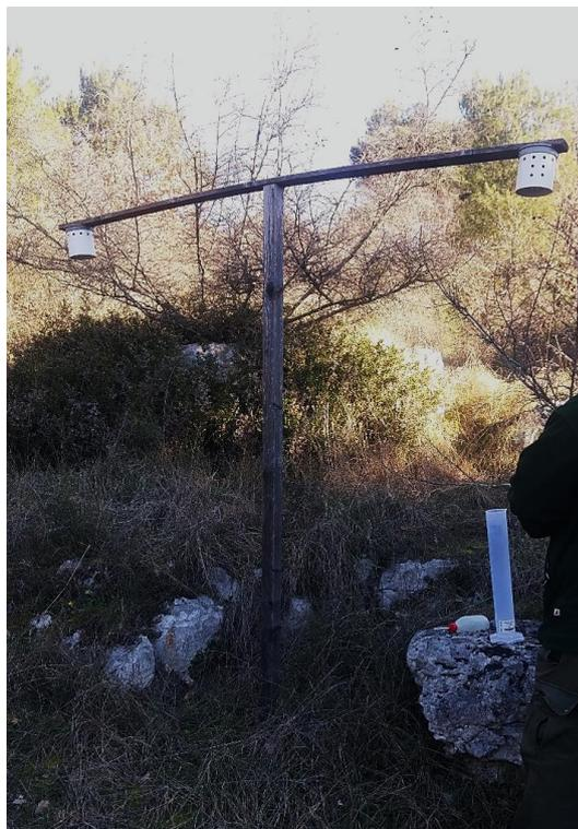
Slika 3.12.1. Pasivno mjerenje ozona na plohi Poreč
